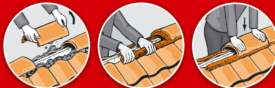
Befestigung von Firsten und Gratziegeln
